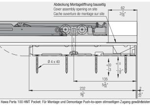
Hawa Porta 100 HMT Pocket: For mounting and dismounting of the Push-to-open ensure a frontal access Hawa Porta 100 HMT Pocket: Pour le montage et le démontage du Push-to-open assurez un accès frontal
